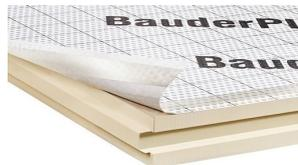
Aufsparrenelement mit beidseitiger Mineralvlieskaschierung, oberseitig diffusionsoffene, blendfreie Textilbahn, zweiseitig überlappend, vertikal und horizontal selbstklebend. Nut- und Federsystem umlaufend.
