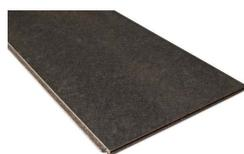
Diffusionsoffene, durchgehend bituminierte Wandbauplatte mit Nut- und Feder-Verbindung für vorgehängte Fassaden mit offenen Fugen bis 20 mm. Robuste Oberfläche bei UV-Belastung.
