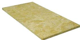
Die Trittschall-Dämmplatte TPS aus hochverdichteter Steinwolle sorgt für die Tritt- und Luftschalldämmung sowie Wärmedämmung von Fußböden bzw. Geschosdecken unter Nassestrichen.
