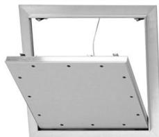
Stabiler Alurahmen mit Gipskarton-Einlage 12,5 mm (GKB-I ohne Feuerwiderstand) und herausnehmbare Klappe mit Druckverschluss für den Wand- und Deckeneinbau.
