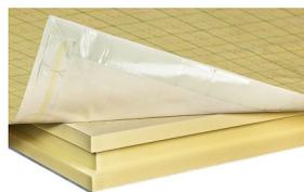
Beidseitig Mineralvlies, oberseitig diffusionsoffene Unterdeckbahn zweiseitig überlappend, vertikal und horizontal selbstklebend. Polyurethan-Hartschaum. Nut- und Federsystem umlaufend.
