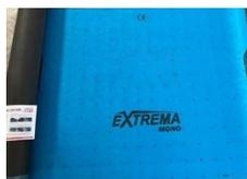
Diffusionsoffene, monolithische Schaltungsbahn mit 2 integrierten Klebestreifen für erhöht regensichere Unterdächer ab 2° Dachneigung. Quer- und Anschlüsse werden mit Dihabond Elastic Pro verklebt.
