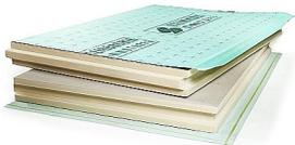
Aufdachdämmelement mit beidseitiger, diffusionsoffener Beschichtung (obere Deckschicht grün eingefärbt mit Rasteraufdruck) Längs- und Querüberlappung mit Klebestreifen. Polyurethan-Hartschaum, Nut- und Federsystem umlaufend. Nur in ganzen Paketen erhältlich.
