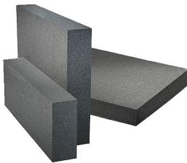
Schaumglas aus hochwertigem recyceltem Glas. Wärmedämmung unter Abdichtungen für genutzte und ungenutzte Flachdächer, befahrbare Flächen (Parkdächer), begehbare Flächen (Balkone, Terrassen), unter Deckungen (Steildach, Metaldach), für Innendecken und -wände, für Luftschachtdämmung, unter schwimmendem Estrich, von Wänden hinter Bekleidungen und Abdichtungen, gegen Erdreich (Perimeterbereich der Wand) und unter lastabtragenden Gründungsplatten/Fundamenten.
