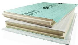
Diffusionsdichtes Aufsparrenelement zur Dämmung von geneigten Dächern. Mit beidseitiger Reinalu-Beschichtung, aufkaschierter, diffusionsoffener Deckschicht mit selbstklebender Längs- und Querüberlappung sowie Rasteraufdruck und Klebestreifen. Polyurethan-Hartschaum. Nut- und Federsystem umlaufend. Nur in ganzen Paketen erhältlich.
