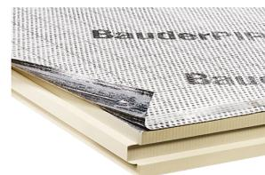
Aufsparrenelement mit beidseitig diffusionsdichter Alufolie, oberseitige Polymerbitumenbahn, zweiseitig überlappend, vertikal und horizontal selbstklebend. Polyurethan-Hartschaum, Nut- und Federsystem umlaufend.
