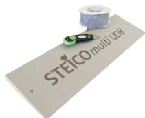
Hydrophobierte Holzfaser-Dämmplatte mit aufkaschierter Funktionsbahn und integriertem Attika-Kunststoffprofil 2.0 mit Tropfkante und Glasfasergewebe. Zur Montage unter Fensterbänken als zweite wasserführende Ebene.
