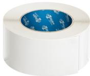
Trenn-Fix mit ca. 10 mm breitem, selbstklebendem und lösungsmittelfreiem Klebestreifen zum Anschluss von Trockenbauflächen an massive Bauteile bzw. zur gleitenden Trennung von Trockenbauflächen sowie zur Trennung von Putzflächen anstelle eines „Kellenschnittes“.
