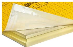
Aufsparrendämmelement mit beidseitig diffusionsdichter Alufolie, oberseitig diffusionsoffene Unterdeckbahn, zweiseitig überlappend, vertikal und horizontal selbstklebend. Polyurethan-Hartschaum, Nut- und Federsystem umlaufend.
