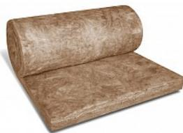
Nicht belastbare Wärme- und Schalldämmung mit Markierungsstreifen für den Dachausbau und Holzriegelbau. Zum Einklemmen zwischen Holztragkonstruktionen.
