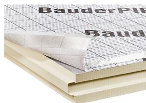
Aufsparrenelement mit beidseitig diffusionsdichter Alufolie, oberseitig diffusionsoffene blendfreie Spezialbahn, zweiseitig überlappend, vertikal und horizontal selbstklebend. Nut- und Federsystem umlaufend.
