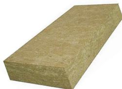
Steinwolle-Steildachdämmplatte, druckbelastbar, nicht brennbar, wärme- und schalldämmend, wasserabweisend, unverrottbar, form- und alterungsbeständig. Zur Wärme- und Schalldämmungen sowie Brandschutz von Steildächern als Aufsparrendämmung. Die Verlegung erfolgt ein- oder zweilagig auf vollflächiger Holzschalung oder Holzwerkstoffplatten.
