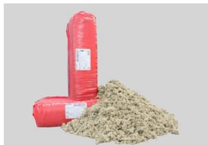
Als Einblasdämmung zur nachträglichen brandschutztechnischen I-90-Ertüchtigung von Installationsschächten durch vollständige Ausfüllung des Hohlraumes.
