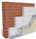
Dämmplatte für Außenwand-Wärmedämmverbundsysteme (WDVS).
