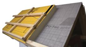
Diffusionshemmende Dampfbremse für Aufsparrendämmungen mit rutschhemmender Oberfläche mit Rasteraufdruck und mit 2 Nahtselbstklebestreifen für die optimale Verklebung der Überlappungen.
