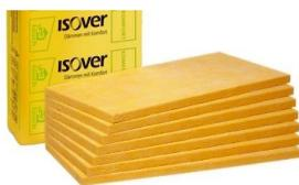
Mineralwolle-Trittschall-Dämmplatte, zulässige Auflast bis zu 6,5 kPa (650 kg/m<sup>2</sup>). Unter schwimmenden Estrichen auch mit Fliesenbelägen.
