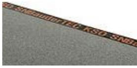
Beschieferte Elastomerbitumen-Oberlagsbahn mit Gittereinlage, kaltselbstklebend und mit Schweißnaht.
