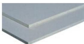
Bestehend aus 2 miteinander verklebten 10 mm oder 12,5 mm dicken Gipsfaser Platten, die beiden Platten sind gegeneinander versetzt angeordnet, sodass ein 50 mm breiter Stufenfalz entsteht
