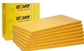
Mineralwolle-Trittschall-Dämmplatte, zulässige Auflast bis zu 10 kPa (1000 kg/m<sup>2</sup>). Unter schwimmenden Estrichen auch mit Fliesenbelägen.
