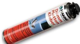
Einkomponentiger PU-Pistolenschäum zur Verklebung von Dämmplatten als Perimeterdämmung an Kelleraußenwänden. Gute Haftung auf Beton, Mauerwerk, Holz, Metall und bituminösen Untergründen.
