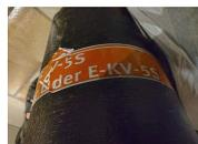
Beschieferte Elastomerbitumen Schweißbahn.
